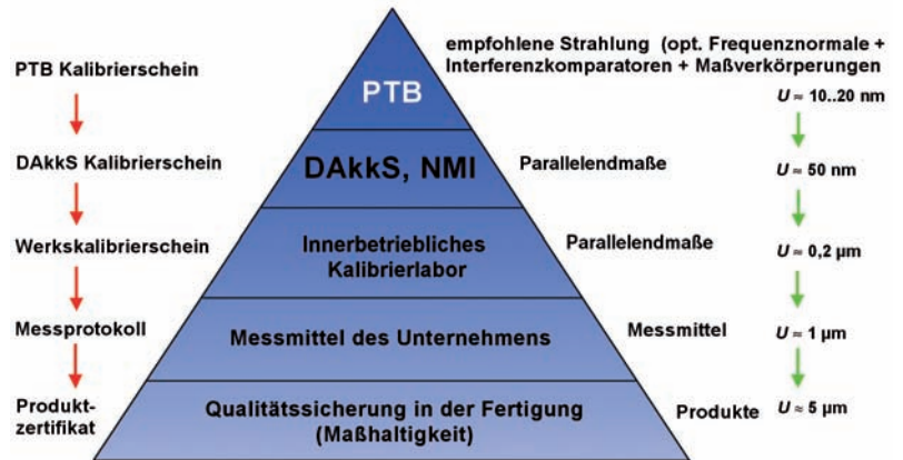
Bild 2: Kette der Rückführung für die Längeneinheit Meter
